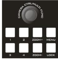
切换台支持 4 路摄像机控制，可以通过摇杆对 4 路摄像机的远近距离进行控制。
