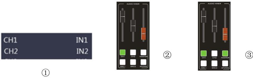
3、操作调音台控制区域，循环按下 SRC2 按键进入第二路音频通道选择 IN1、IN2、IN3、IN4，对应菜单状态栏会实时根据你的选择进行变化（如图①所示）
