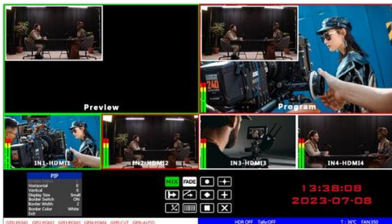
此时的液晶屏上的信息会切换到 PIP 画中画设置，按下旋钮后可根据需求设置。
