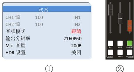
2、音频跟随的通道有 IN1-HDMI1//DP1、IN2-HDMI2/DP2、IN3-HDMI3/DP3、IN4- HDMI4/DP4 对应的操作面板按键
